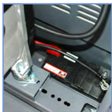
Batteria d'avviamento al piombo fornita precaricata e pronta all'uso
